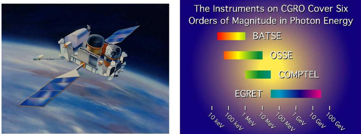
Figura 1.3: A sinistra: figura del Compton Gamma Ray Observatory. A destra: range energetico degli strumenti a bordo del CGRO.
